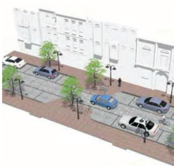
Figura 11 - Exemplo de estreitamento Fonte: WRI Brasil (2016b)
