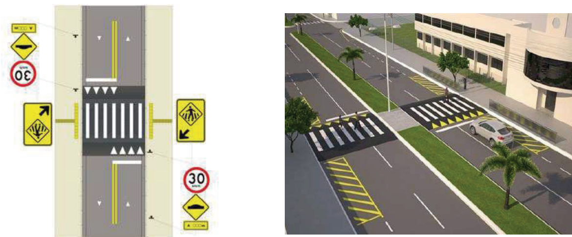
Figura 47 - Sinalização horizontal e vertical para travessia elevada de pedestres Fonte: Brasil, Contran. Resolução nº 738/2018.
