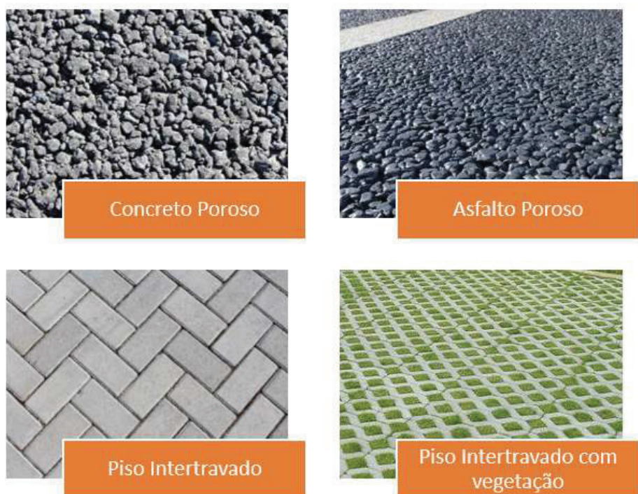
Figura 44 – Tipos de pavimentos permeáveis Fonte: Aguiar (2022)
