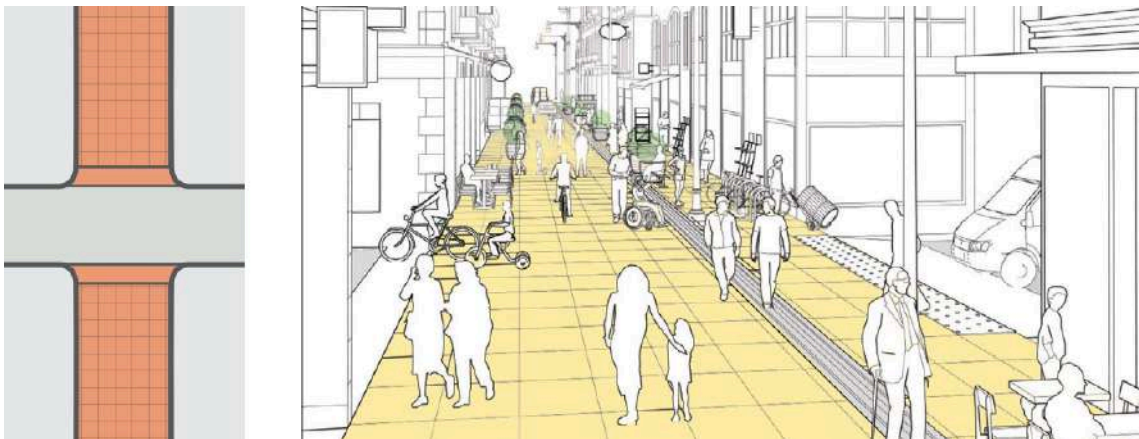
Figura 49 – Exemplo de elevação do leito carroçável para rua compartilhada Fonte: NACTO (2018)
