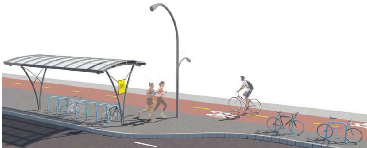
Figura 28 - Instalação de paraciclos em paralelo (esq.) e em linha (dir.) Fonte: Brasil (2017, p. 49)
